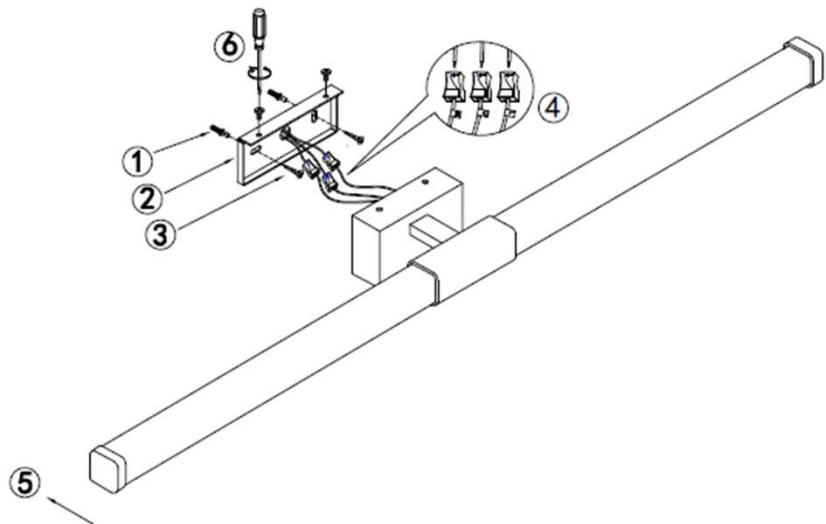
ATTENZIONE: il grado di protezione IP44 è ottenibile se l'apparecchio viene installato su superfici lisce e planari.
